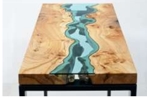
شكل (21) و قد تم دمج الخشب الطبيعي مع اجزاء متعرجه القطع باستخدام تكنولوجيا Water Jet في ترابيزه ذات قاعده حديديه.
